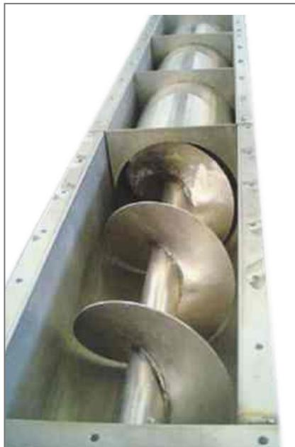
اسکرو کانوایرهای شرکت فن آوران هوا سیستم در سایزهای استاندارد ساخته می‌شود و می‌توان تعداد ماربیچ‌های داخل را تا ۱۰ ماربیچ در یکدستگاه در نظر گرفت و به این صورت انتقال مواد با مصرف انرژی کمتر بصورت یکنواخت انجام می‌گردد.
